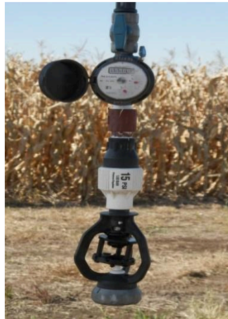
Figura 2: Hidrómetros utilizados en la determinación de los caudales de cada aspersor.
