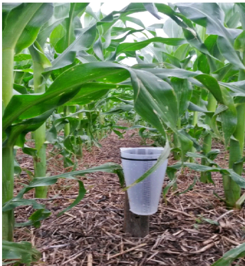
Figura 4. a) Ubicación de colectores en el interfilar del cultivo de maíz (izquierda) y b) colectores en la condición Testigo sin cultivo (derecha).
